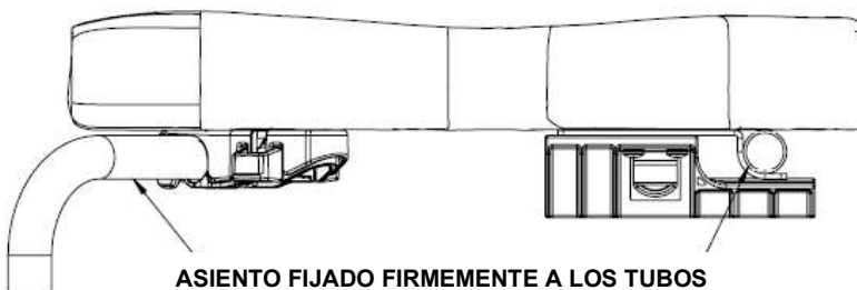
ASIENTO FIJADO FIRMEMENTE A LOS TUBOS DE SOPORTE DELANTERO Y TRASERO
